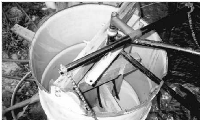
Внутри самодельной стиральной машины из бочки.
